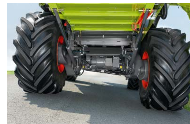
MONTANA přední náprava s maximálním vychýlením
