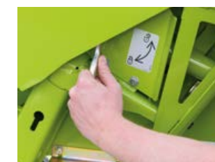
Zajištění děliče bez použití nářadí přes rychloupínání
