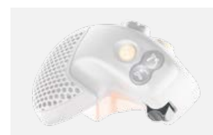
Přestavení stolu žacího ústrojí VARIO, kosy MAXFLEX a rychlosti přepravního pásu MAXFLO na multifunkční ovládací páce CMOTION
