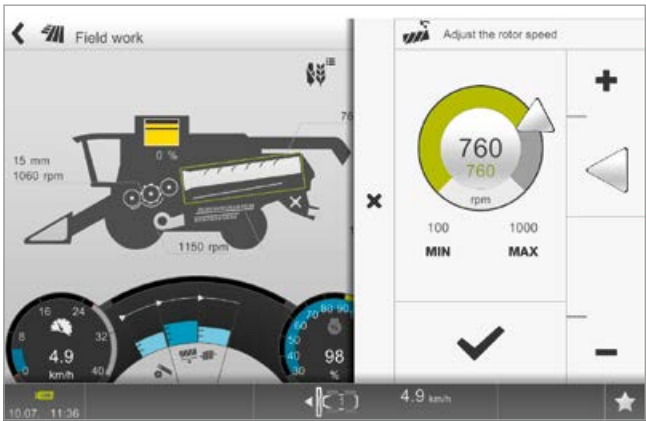
Nastavení otáček rotoru v systému CEBIS
