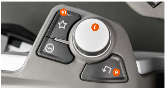
Ovládací pole CEBIS: ovladač (8), tlačítko Escape (9), správa oblíbených položek (10)
