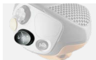
Aktivace regulace výšky strniště (AUTO CONTOUR), regulace tlaku a volba výšky strniště i zvedání / spouštění adaptéru přímo na multifunkční ovládací páce CMOTION
