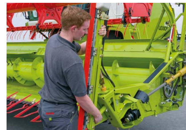
Připojení řepkového děliče přes rychloupínání
