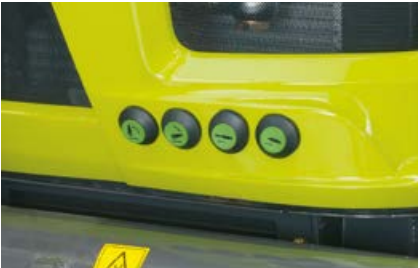
Čelní zvedací závěs a jeden hydraulický rozvaděč lze pohodlně ovládat pomocí tlačítek v přední části kapoty motoru .
