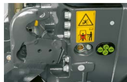
Externí ovládání pro čelní zvedací závěs a jeden rozvaděč
