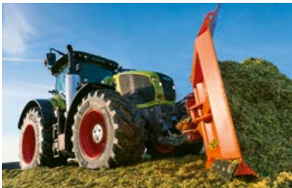
Ve spojení s čelním zvedacím závěsem jsou k dostání až dva dvojčinné hydraulické rozvaděče a jedna volná zpátečka na čelní závěs. Ideální pro zásobník osiva nebo shrnovací radlici v čelním připojení.
