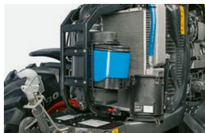
Vzduchový filtr motoru nacházející se před chladičem je dobře přístupný ze země.
