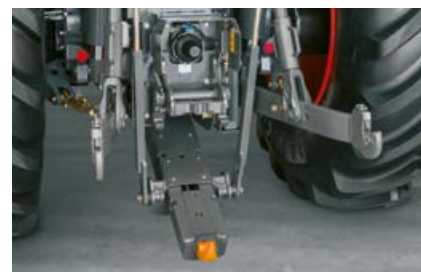
Připojení pomocí agroháku je alternativou k závěsnému nosiči odpovídajícího normě ISO-500.
