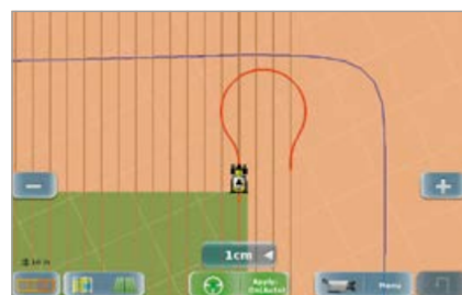
S AUTO TURN se traktor automaticky otáčí na souvrati.
