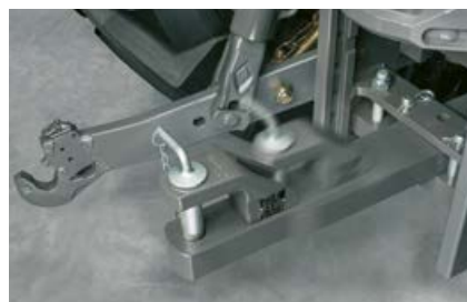
Varianty tažné lišty nabízí více pozic. Vytažená pozice umožňuje lepší obratnost.
