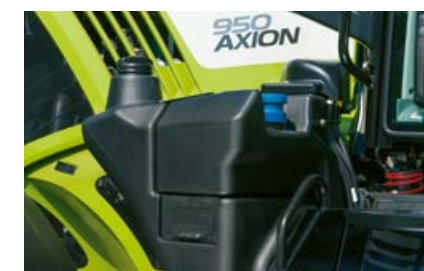
640 l palivová nádrž s integrovanou nádrží na močovinu o objemu 56 l
