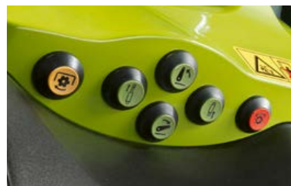
Externí obslužné prvky pro zadní zvedací závěs, vývodový hřídel a jeden volitelný rozvaděč
