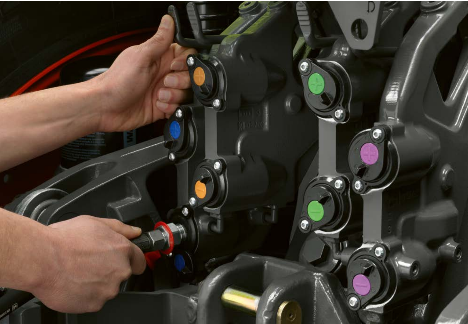
Na čelním zvedacím závěsu se nacházejí přípojky pro rozvaděč a volný zpětný chod
