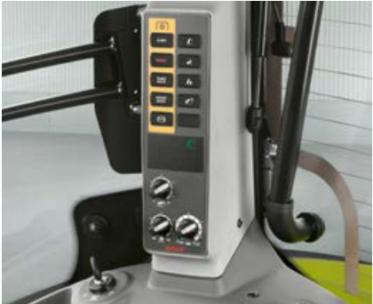
Otáčky vývodového hřídele a elektronická regulace zvedacího závěsu jsou nastavitelné na B-sloupku
