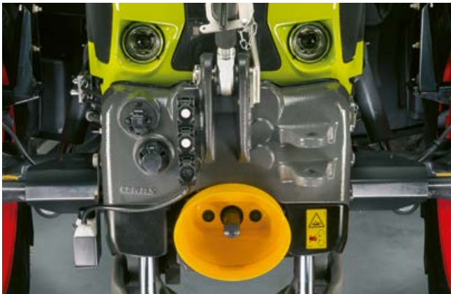
Na čelním zvedacím závěsu se nacházejí přípojky pro rozvaděč a volný zpětný chod
