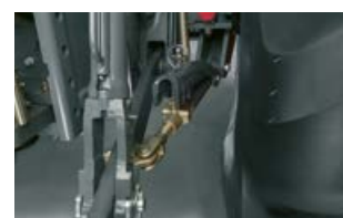
Automatické stabilizátory dolních táhel
