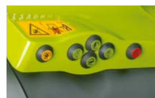
Externí obslužné prvky pro zadní zvedací závěs, vývodový hřídel a jeden volitelný rozvaděč (pouze CEBIS)
