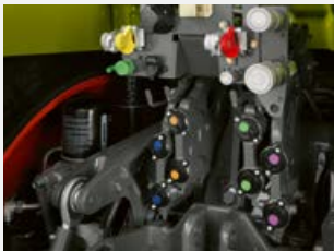
NOVINKA: Vzduchová brzdová soustava s vysoušečem vzduchu
