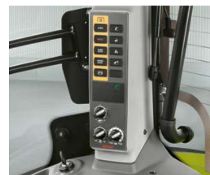
Rychlost otáček vývodového hřídele a elektronická regulace zvedacího závěsu jsou nastavitelné na B-sloupku
